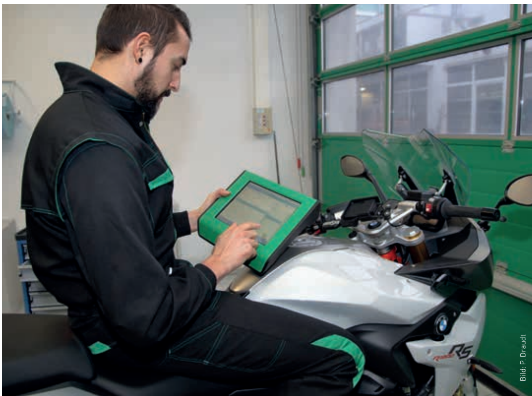
Das Top-Gerät mega macs 56 Bike mit Touchscreen lässt sich durch Hardware-Einschübe optional erweitern.
