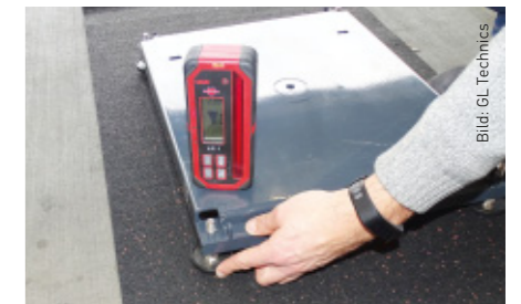
Das Nivellierplattensystem kann Höhenunterschiede des Bodens von bis zu 40 mm ausgleichen.
