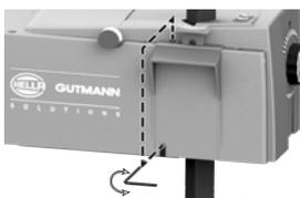
Seitliche Öffnungen zum Nachstellen der Gleitstücke der Säulenführung mit einem Sechskantschlüssel SW6.
